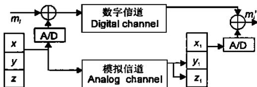
图 5 驱动响应式 Chua 电路混沌同步数据保密通信系统
