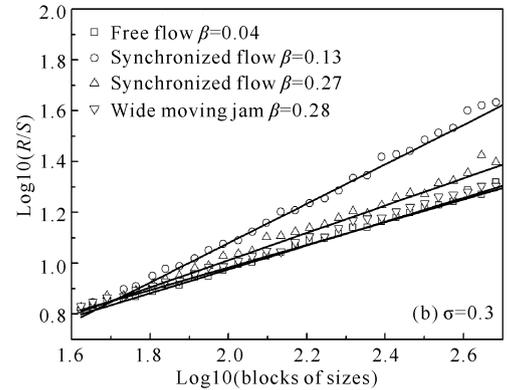
图 4 样本重标极差  $R/S$  的平均值与样本长度  $s$  的关系
