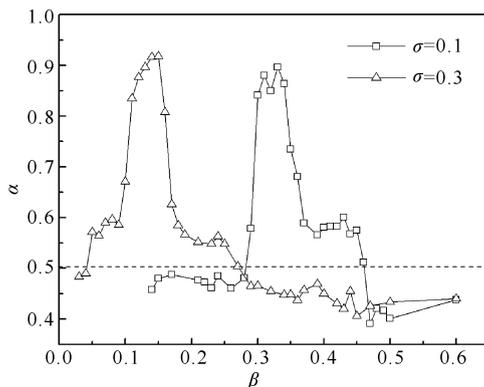
图 13 不同的左车道进车概率  $\sigma$  下标度指数与右车道进车概率  $\beta$  的关系
