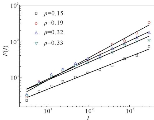
图 8 去趋势波动的均方根  $F(l)$  和时间增量  $l$  的标度关系
