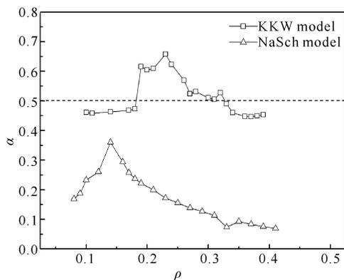
图 10 在 KKW 模型和 NaSch 模型下, 标度指数  $\alpha$  与道路密度的关系
