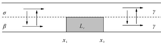
图 1 局部道路缩减的双车道模型结构
