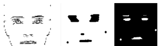
(a)边缘检测 (b)形态学处理 (c)逻辑处理 Edge detection Morphological processing Logical processing
