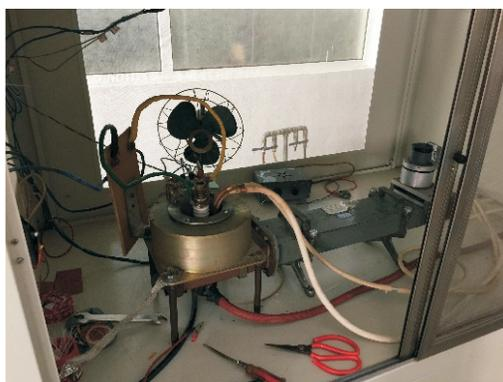
图 10 磁控管实际使用场景
