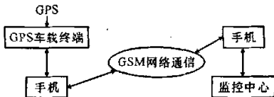
图 1 GPS/GIS/GSM 智能公交系统结构
