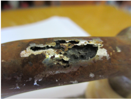
图 4 D型卸扣腐蚀细节照片
